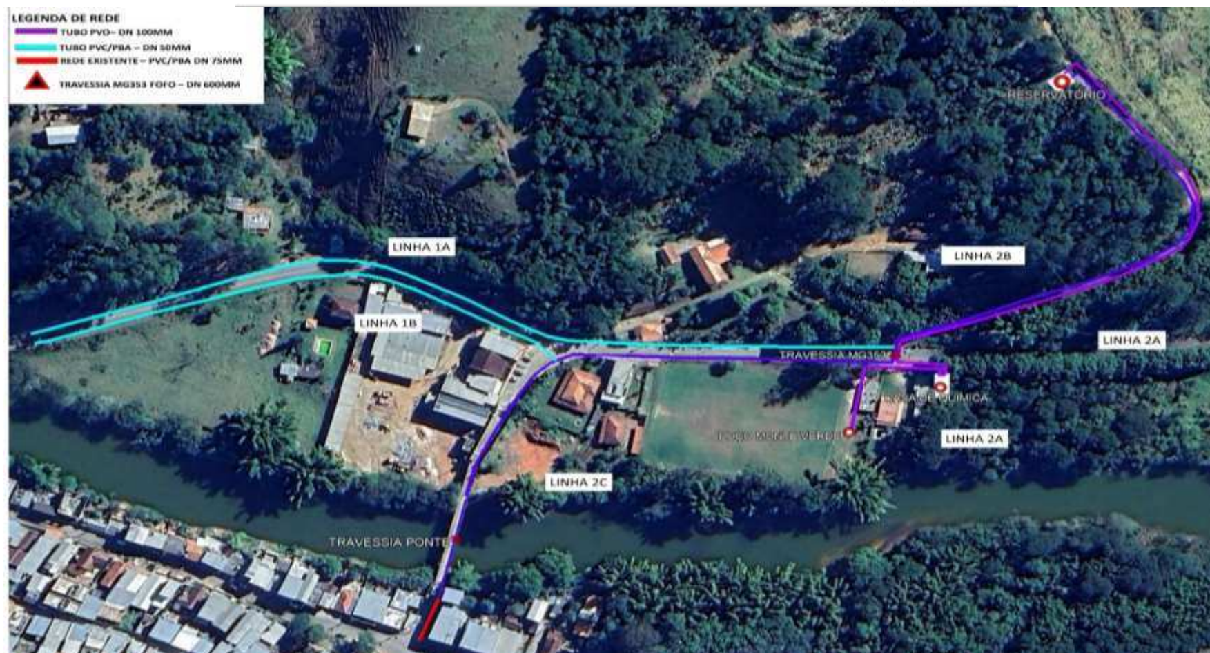
Figura 7: Projeto de Implantação da 2ª Fase do Sistema de Abastecimento de Água do Distrito de Monte Verde.
