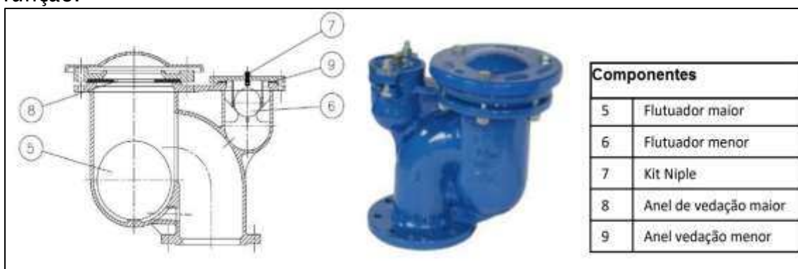
Figura 10 Exemplo ilustrativo de uma ventosa tríplice função.
