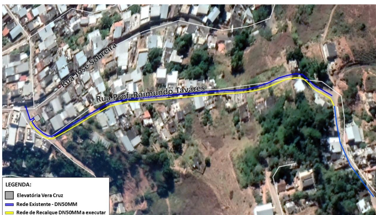
Figura 3 – Rede de Recalque.
