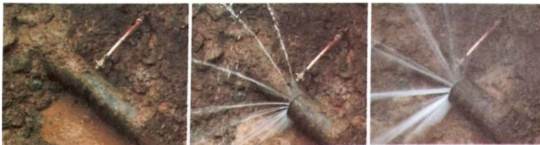
Figura 1 - Influência da pressão em um vazamento.
