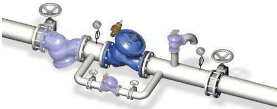
Figura 4 - Sistema de redução de pressão - instalação típica.
