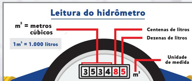
O ponteiro do hidrômetro indica se há vazamento na tubulação que leva a água até a caixa d'água. Faça o seguinte teste: mantenha aberto o registro padrão, feche bem todas as torneiras da casa e não utilize os sanitários. Vede todas as boias das caixas. Marque a posição do ponteiro vermelho do hidrômetro e, após 10 minutos, verifique se ele se movimentou. Se o ponteiro se mexer é sinal de que existe um vazamento no ramal alimentado diretamente pela rede.
